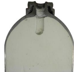
Schnitt einer C 2 H 2 -Flasche
